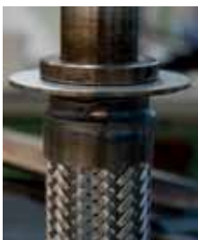
fertig geschweisster Schlauch Tuyau terminé
