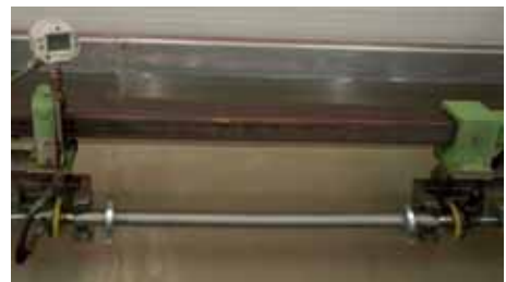
Druckprüfungen der Schläuche Test sous pression des tuyaux
