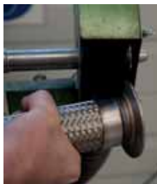
Polieren der Schweissnaht Polissage du cordon de soudure
