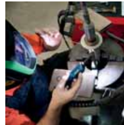
2. Schweissvorgang: Anschweissen der Armaturen Processus de soudage: soudure des armatures
